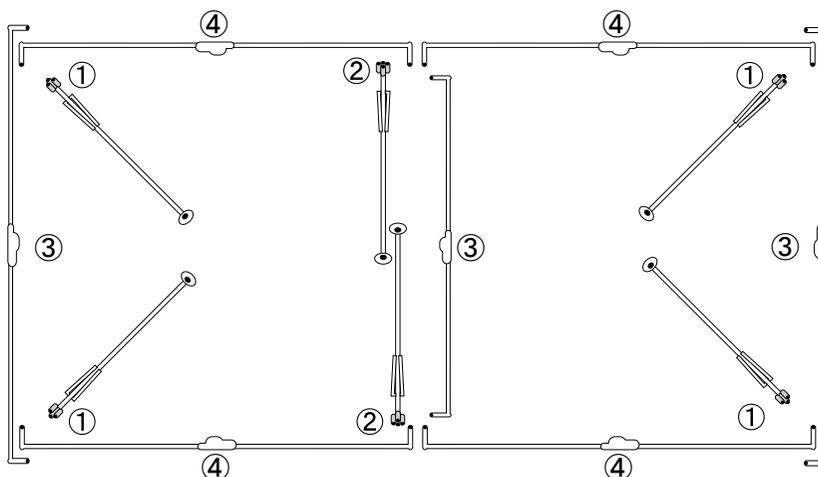
(3) 鉄骨を組みます。柱（①・②）にある3つもしくは4つある穴のうち、左右にある穴に梁（③・④）を差し込み、土台を組みます。鉄骨を組みます。その後合掌（⑤）を棟（⑥）に差し込んでから、柱（①・②）の一番外側に差し込みます。
