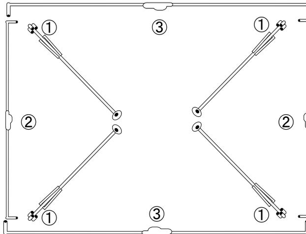
(3) 鉄骨を組みます。角柱（①）にある3つの穴のうち、左右にある穴に梁（②・③）を差し込み、土台を組みます。その後合掌（④）を棟（⑤）に差し込んでから、角柱（①）の一番外側に差し込みます。
